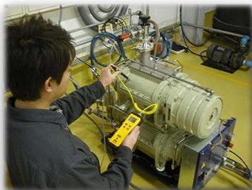
干泵振动测试现场
