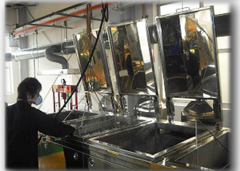
干泵零件清洗现场
