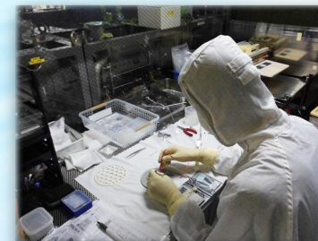
P-5000 CVD设备 基座翻新作业场景
